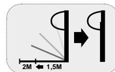
**Hochklappbarer Profi-Bodenrahmen in superstabiler Ausführung.** Gefertigt aus extra starkem Alu-Profil 75 x 40 mm. Völlig im Inneren des Profiles liegende Netzbefestigung „Power Press“ verringert die Verletzungsgefahr. Lieferbar in zwei verschiedenen Versionen: Ausladung 1,5 m oder 2 m. Passend für unsere Erwachsenentore in Bodenhülsen.
